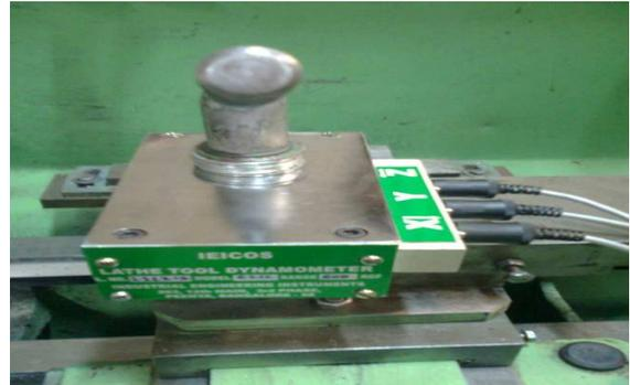
Fig. 4 Lath Tool dynamometer
